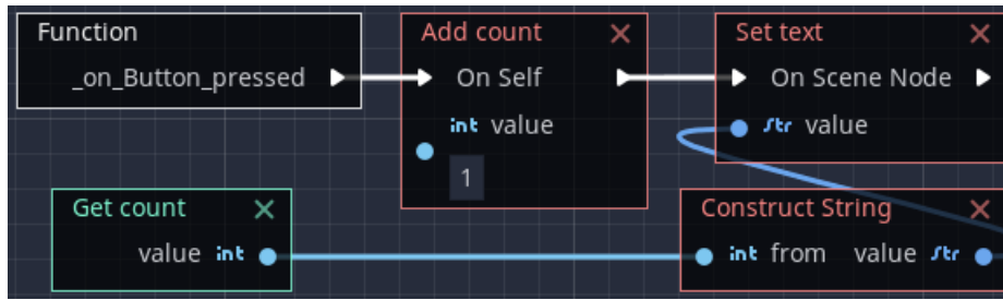
Figure 5.11: VS Incrémenter un label avec une fonction
